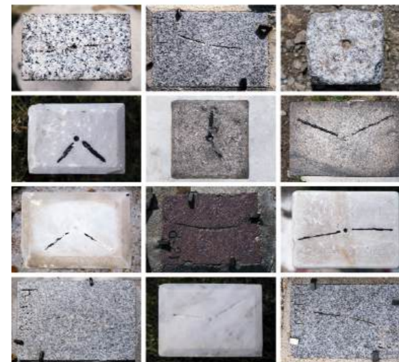
Grenzsteine, vom Menschen gemacht: Manche sind aus Beton oder Granit, behauen oder unbehauen, mit Kreuzen, Punkten oder Strichen versehen.
